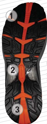
ПОДОШВА ПОЛИУРЕТАН/РЕЗИНА 1. Зона изгиба для большей гибкости 2. Резиновая подошва для оптимального сцепления 3. Подошва композитная с защитой от прокалывания, гибкая.
