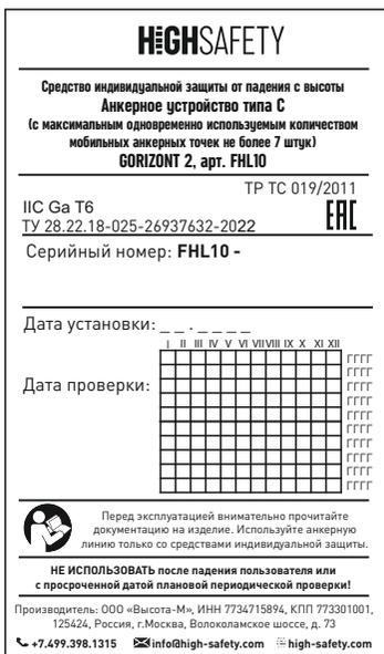
Рис. 3 Маркировка информационной таблички анкерной линии GORIZONT 2.
