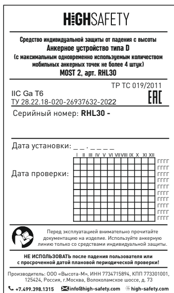
Рис. 3 Маркировка информационной таблички анкерной линии MOST 2.
