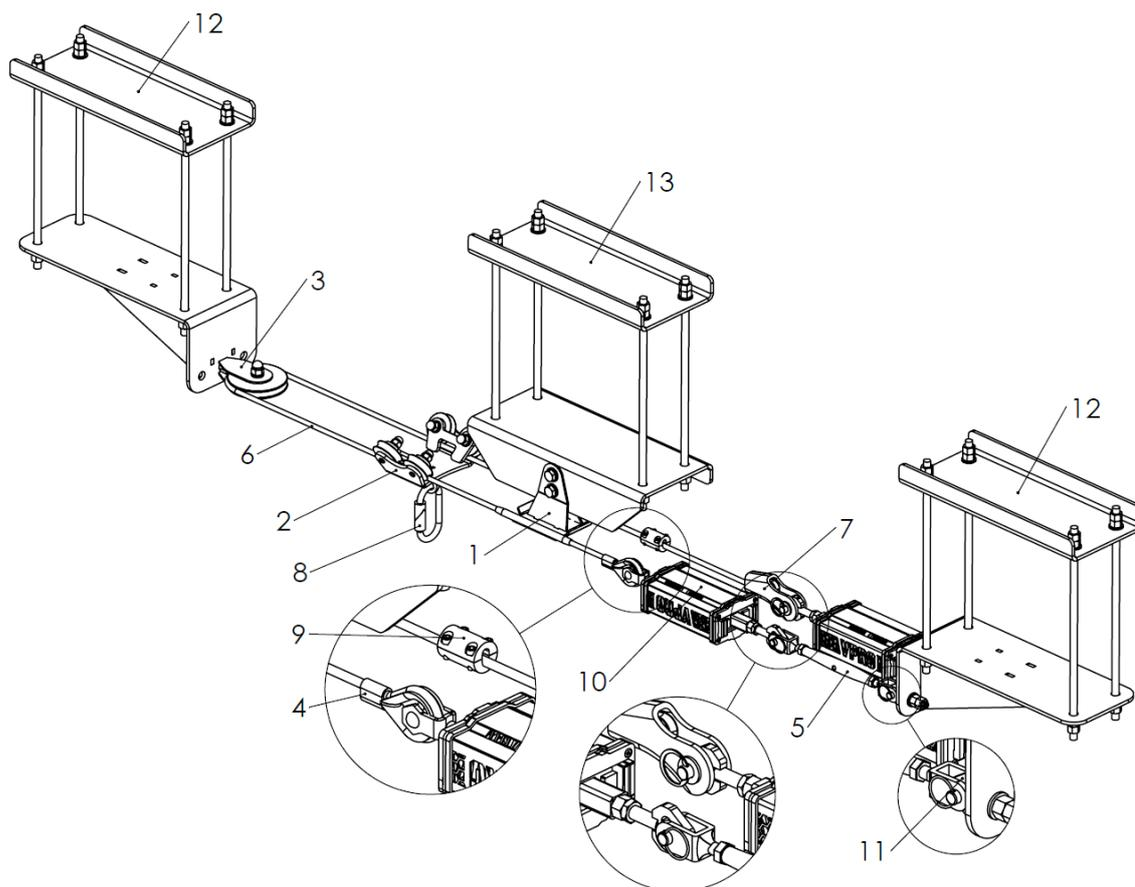
Рис.2 Монтаж анкерной линии
