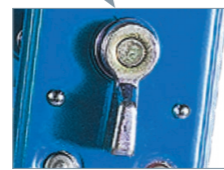
Переключатель позволяет изменять режим опускания / подъема.
