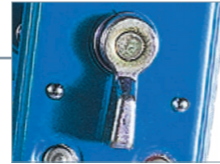
Переключатель позволяет изменять режим опускания / подъема.
